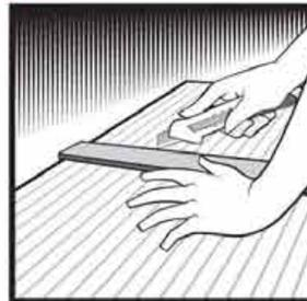
Se recomienda cortar el Makrolon con una navaja ó cutter, cortando por ambas caras del material, también se puede utilizar una sierra de diente fino, siempre y cuando se trate de espesores menores a 16 mm.
